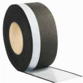
DRG-Fensteranschlussfolie aussen besteht aus einem überputzbaren Vliesverbund einseitig oder wechselseitig mit Selbstklebung wahlweise Disersions-Acrylatstreife oder Butyl kaschier. Die Anschlussfolie aussen dient zur schnellen und sicheren äusseren, luftdichten und dampfbremsenden Abdichtung von Fensteranschlussfugen und kann auch als überputzbare äussere Abdichtung verwendet werden.
