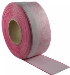
DRG-Fensteranschlussfolie innen besteht aus einem überputzbaren Vliesverbund einseitig oder wechselseitig mit Selbstklebung wahlweise Disersions-Acrylatstreife oder Butyl kaschier. Die Anschlussfolie innen dient zur schnellen und sicheren inneren, luftdichten und dampfbremsenden Abdichtung von Fensteranschlussfugen und kann auch als überputzbare innere Abdichtung verwendet werden.
